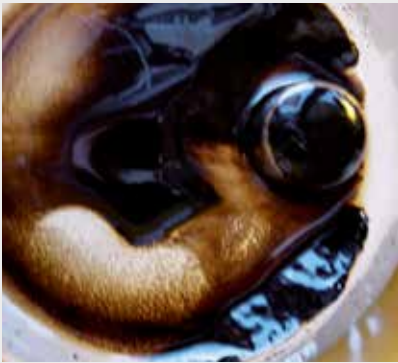
Schlechte thermische Stabilität Starke Ablagerungen
